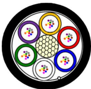
Mikrokabel światłowodowy o konstrukcji 6-tubowej
